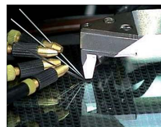
4. ábra Mérőtűk pozicionálása a szilíciumszeleten
