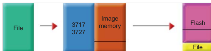
2. ábra A flashbe írás folyamata
